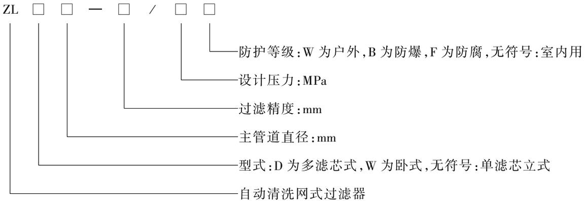
示例：ZLDW 250—0.2/1.0 指过滤精度为 0.2 mm，设计压力 1.0 MPa，管径为 250 mm 的多滤芯卧式室内用自清洗过滤器。
