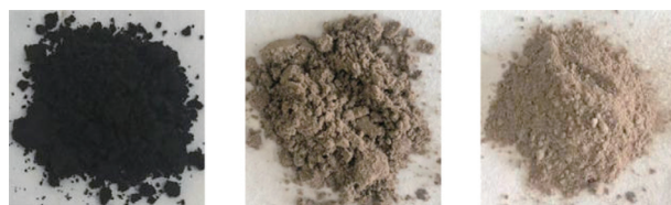
(左:原始油泥;中:竞品清洗后油泥;右: NM-02 清洗后油泥) (b) 大港 1 号油泥清洗后效果
